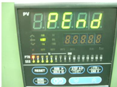
設定完畢後按 ”RESET”，使儀表回到初始的顯示溫度畫面，然後再按 “PTN” 藉由接著按”  $\wedge$  ” 或“  $\vee$  ”選擇剛剛所設定的記憶模組。
